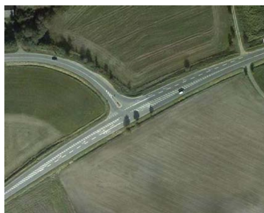
Figur 30: Eksempel på vejforløb med svingbane.
